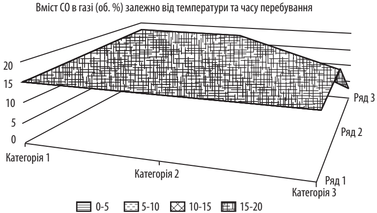
Рис. 4.7. Залежність вмісту CO в генераторному газі (об. %) від температури та часу перебування – температура: ряд 1 – 800 °С; ряд 2 – 900 °С; ряд 3 – 1000 °С; час перебування: категорія 1 – 40 хв; категорія 2 – 50 хв; категорія 3 – 60 хв
