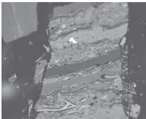
Рис. 3.8. Мікроскопічний вигляд лейптиніту
